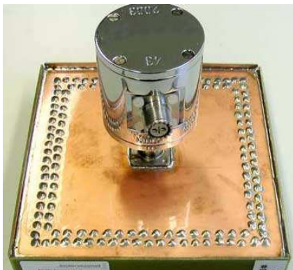
Shunt mit Thermalconverter
