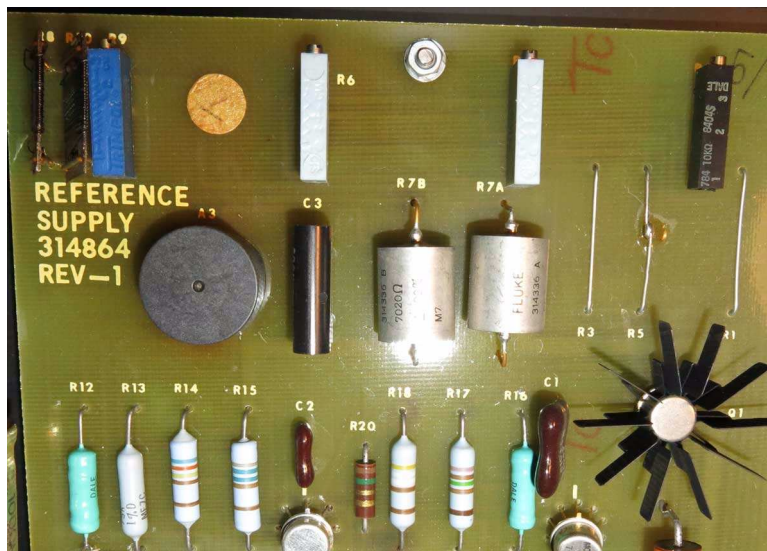
Referenzplatte zu Fluke 335 (siehe Plan oben)
